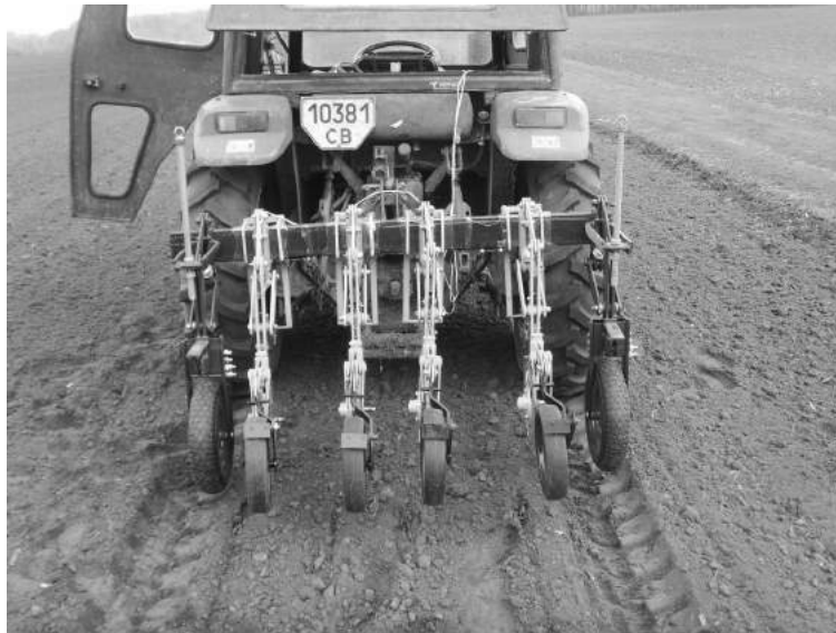
Рис. 15. Агрегативання технічної системи оперативного моніторингу стану сільськогосподарських угідь конструкції Олександра Броварця з транспортним засобом.
