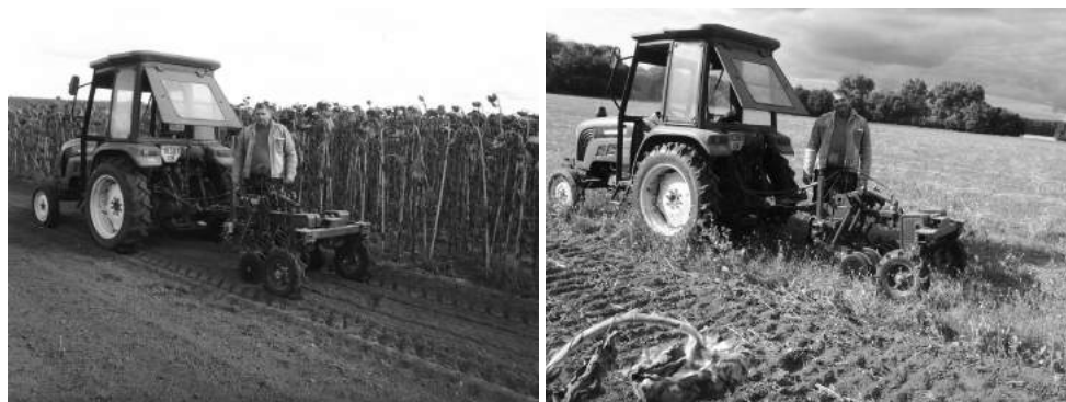
Рис. 7. Функціонування пристрою для визначення електропровідних властивостей ґрунтового середовища на різних типах агрофонів.
