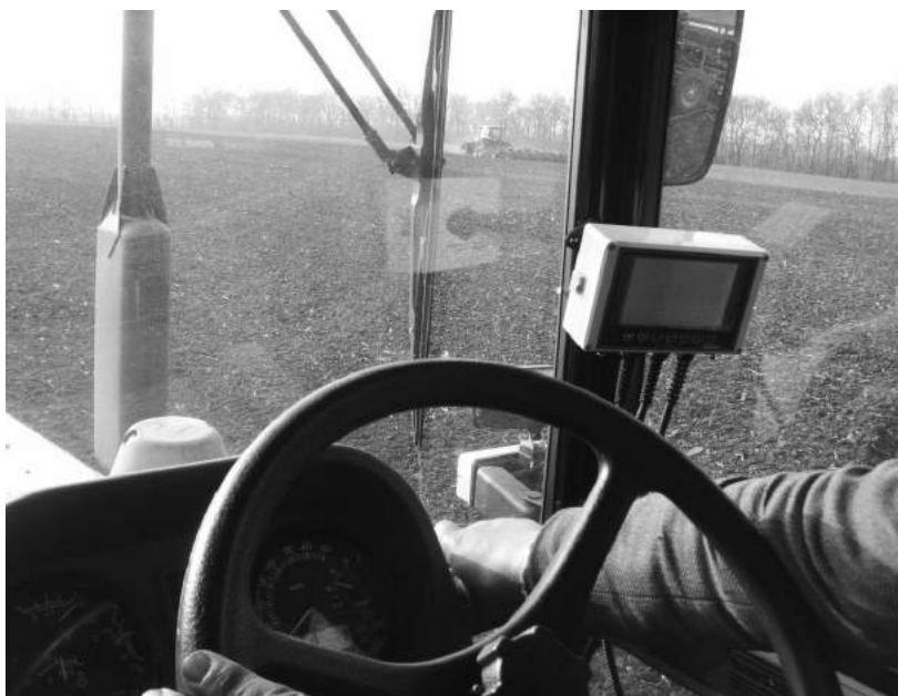
Рис. 10. Розміщення в кабіні енергетичного засобу системи оперативного контролю якості виконання технологічних операцій та системи зворотного зв'язку якості виконання технологічної операції.
