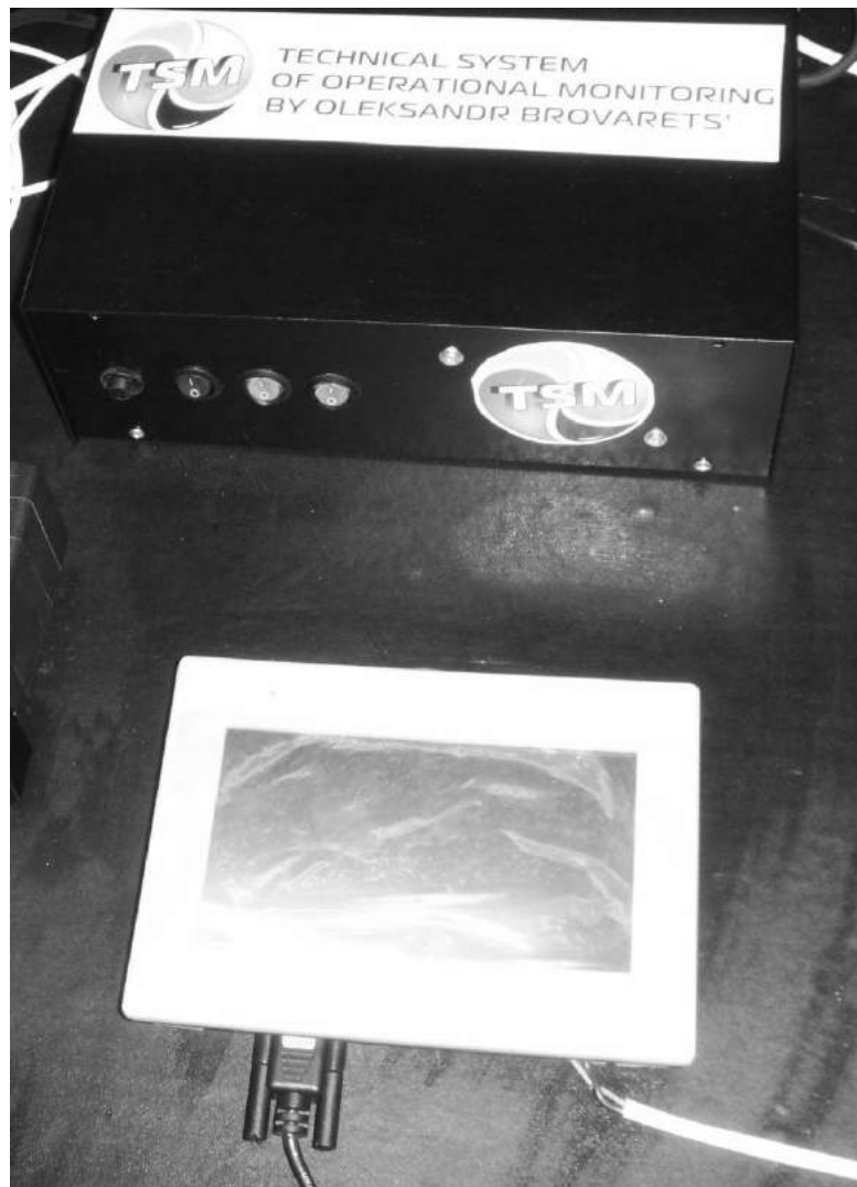
Рис. 17. Дисплей для керування технічною системою оперативного моніторингу стану сільськогосподарських угідь конструкції Олександра Броварця та блок керування.
