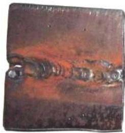
Рис. 1. Обробка вугільним електродом.
