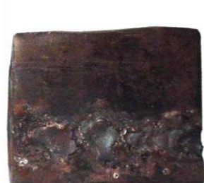
Рис. 3. Обробка графітовим електродом з використанням флюсу.
