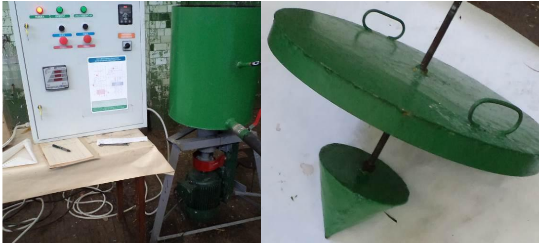
а) експериментально-дослідна установка б) пристрій для ущільнення потоку рідини
