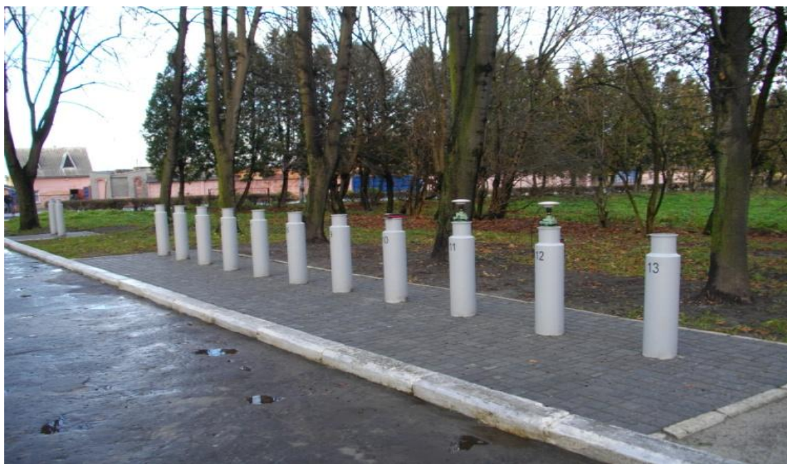
Рис. 1. Еталонний геодезичний базис 2-го розряду в Дублянах
